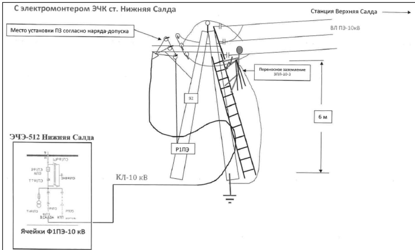
Для устранения неисправности и восстановления кабельной муфты в ячейке выключателя ВФ1ПЭ был вызван электромеханик ремонтно-ревизионного участка (далее – электромеханик 3).
